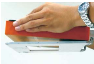
圖6 NB正面朝下，面板與底座開縫狀況
